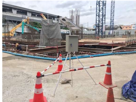
รูปที่ 20 การตรวจวัดความสั่นสะเทือนและระดับเสียง
